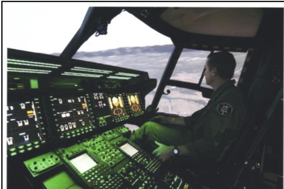
Le Medium Range Training Device (MRTD) en service au CFIA est un simulateur de vol sur base fixe. La qualité d'image est telle que l'on se laisse quand même prendre...
