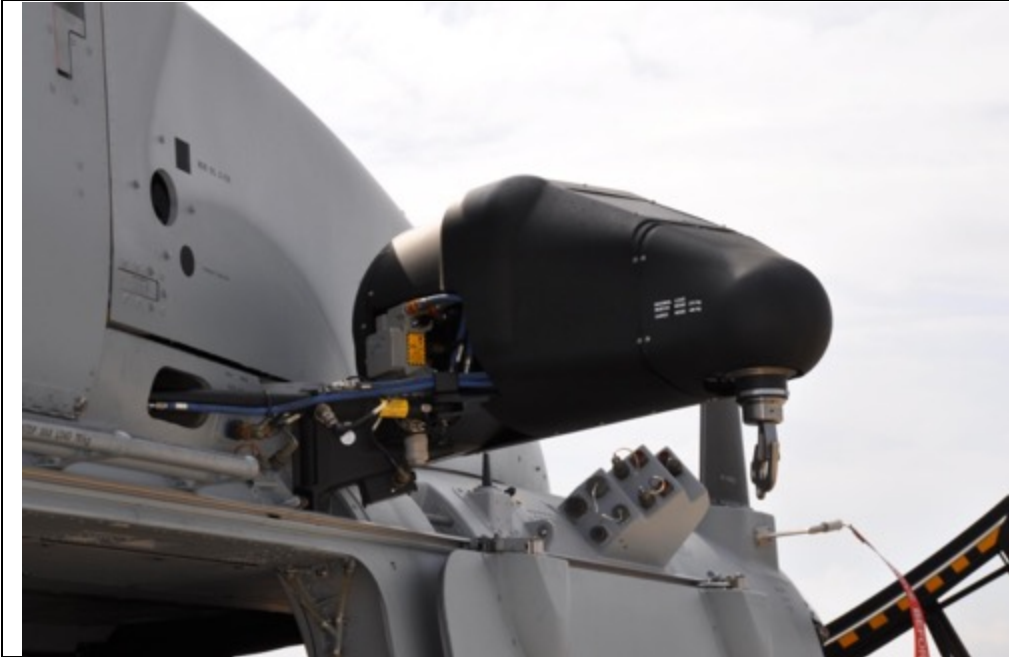
Position du treuil déployé vers l'extérieur :
